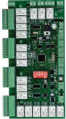
Elevator Controller Bộ kiểm soát thang máy
