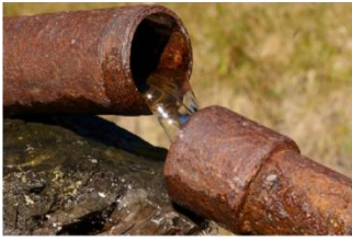
Đường ống cũ gỉ, sét sẽ giải phóng chì và các ion chì vào trong nước.
